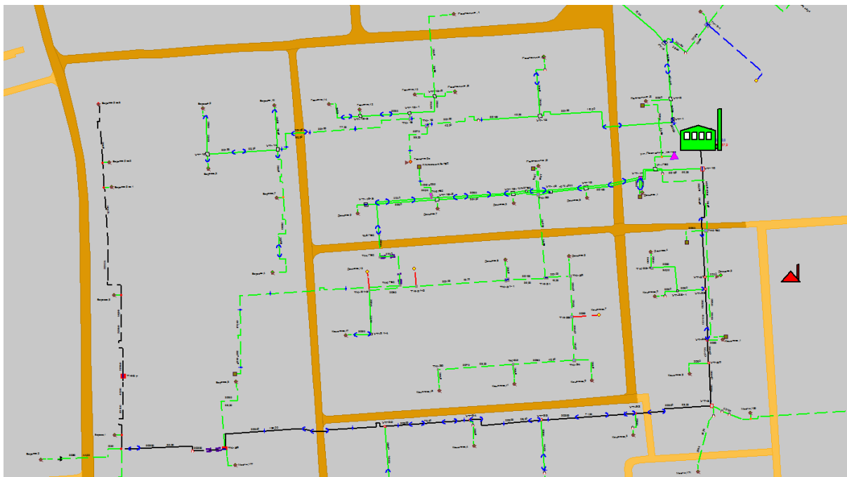
Рисунок 1.137 Результат гидравлического расчета - расчетный путь теплоносителя от котельной Гастелло, 1-а до ПТ-Березов,5 вв3
