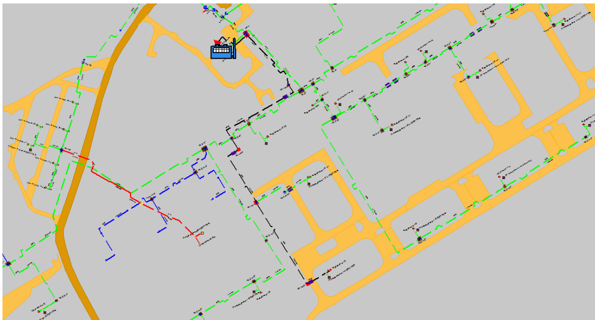
Рисунок 1.165 Результат гидравлического расчета - расчетный путь теплоносителя от котельной Цветочная, 3-а до ПТ-Сахарова,117
