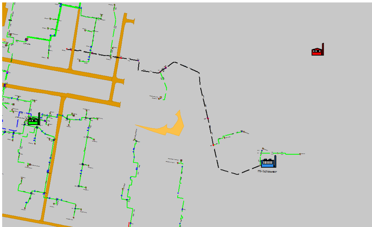
Рисунок 1.225 Результат гидравлического расчета - расчетный путь теплоносителя от котельной Интернациональная, 95 до ПТ-Вольск,11
