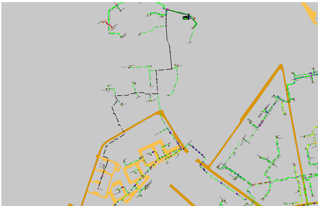
Рисунок 1.27 Результат гидравлического расчета - расчетный путь теплоносителя от котельной пр. Гагарина, 97 до ПТ-Гагар,97 общ.№1
