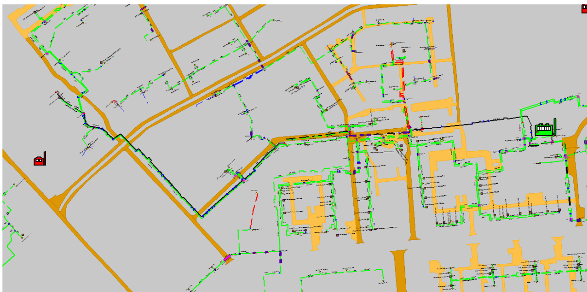
Рисунок 1.99 Результат гидравлического расчета - расчетный путь теплоносителя от котельной Пугачева, 1 до ПТ-Судостр.28
