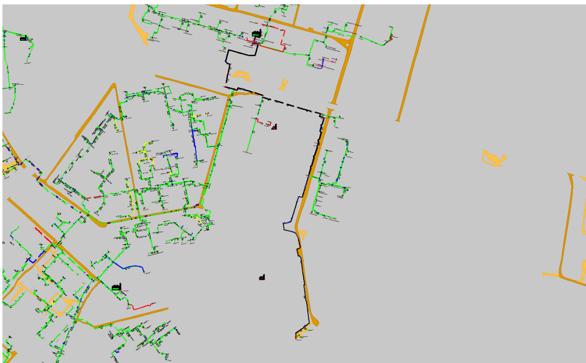
Рисунок 1.51 Результат гидравлического расчета - расчетный путь теплоносителя от котельной пр. Гагарина, 1786 до ПТ-Кащенко, 14а
