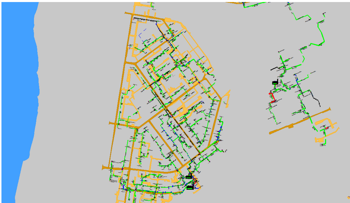
Рисунок 1.145 Результат гидравлического расчета - расчетный путь теплоносителя от котельной Углова, 7 до ПТ-Гагар.пр,104 э2
