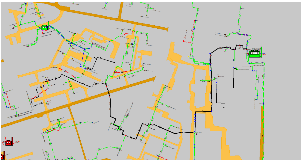
Рисунок 1.19 Результат гидравлического расчета - расчетный путь теплоносителя от Июльских дней, 1 до ПТ-Мендел,6
