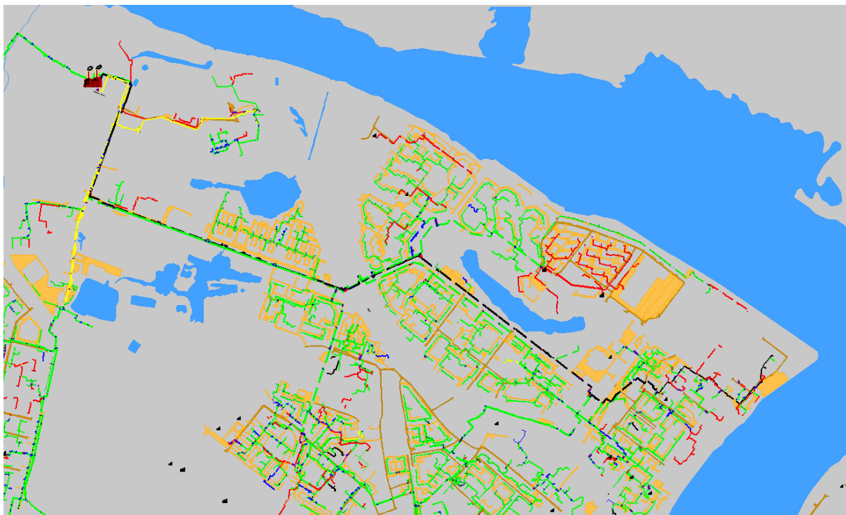
Рисунок 1.5 Результат гидравлического расчета - расчетный путь теплоносителя от СТЭЦ до ПТ-Стрел,19
