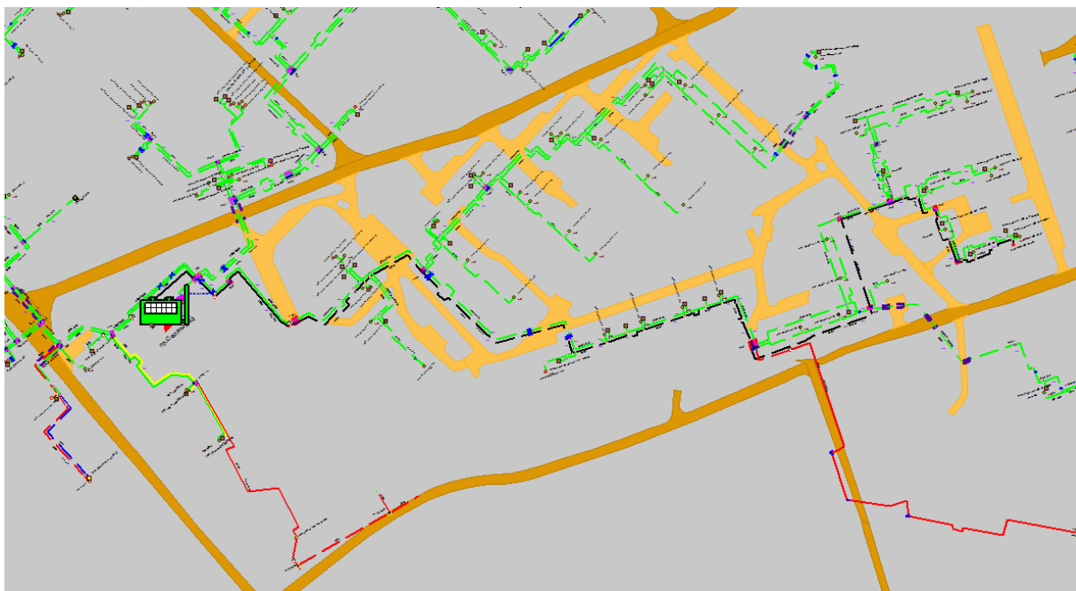
Рисунок 1.57 Результат гидравлического расчета - расчетный путь теплоносителя от котельной пр. Союзный, 43 до ПТ-Комин,256 э2
